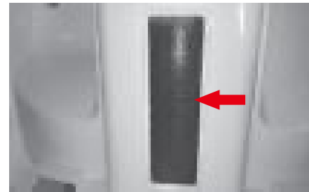
车辆识别代号(VIN) 打印在车架主梁管上
